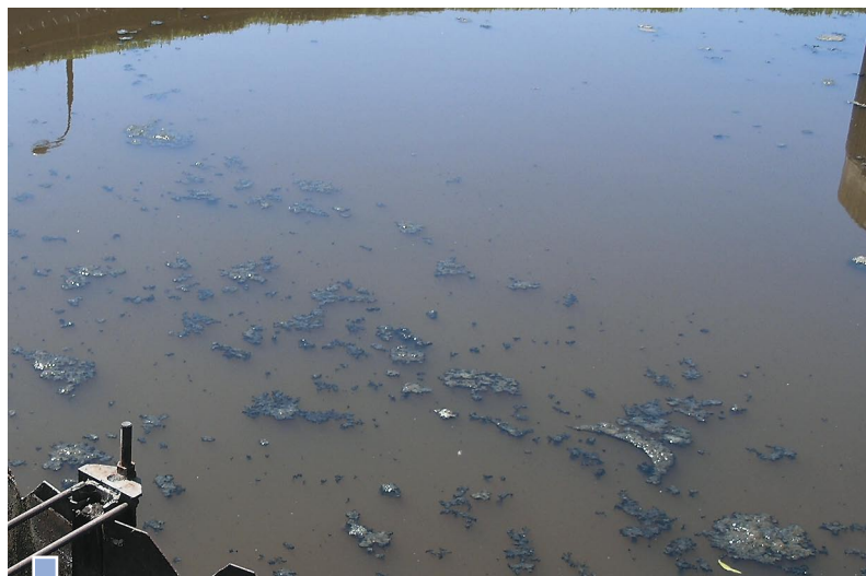
Fot. 2. Wyfotowane „buly” zagniętego osadu czynnego
